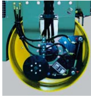
Cortajuntas con compactador de bisel
